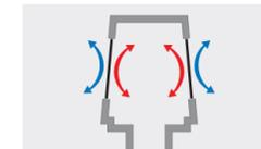
En l'absence d'écoulement d'eaux usées dans la colonne, la fermeture des membranes empêche les pertes d'énergie.
