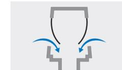
En cas de dépression générée par exemple lors du rinçage des WC, les membranes s'ouvrent et de l'air peut entrer dans le système.
